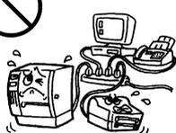
Si la machine partage une même prise électrique avec d'autres appareils consommant beaucoup d'électricité, des fluctuations de tension importantes surviendront lorsque ces appareils fonctionneront. Pour éviter tout risque **d'incendie** ou de **décharge électrique**, ne branchez pas d'autres appareils à la même prise que la machine.
