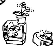
Ne placez pas d'objet métalliques ou de récipients contenant de l'eau (vases, pots de fleurs, tasses, etc.) sur la machine. Si un objet métallique ou un liquide pénètre dans la machine, cela peut provoquer un **incendie** ou une **décharge électrique**.
