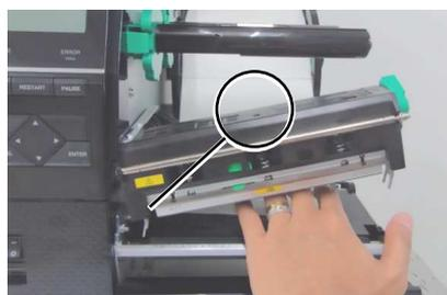
Ne laissez pas d'objets métalliques tels qu'une bague toucher l'arête de la tête d'impression.
