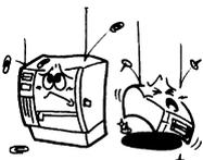
N'introduisez pas ou ne faites pas tomber de pièces métalliques, de matières inflammables ou d'autres objets dans les ouvertures d'aération de la machine. Vous risqueriez de provoquer un **incendie** ou une **décharge électrique**.
