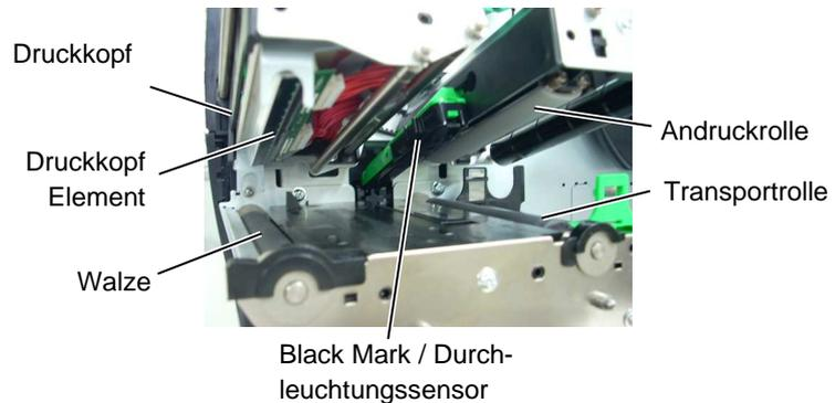
7. Die Walze, Andruck- und Transportrolle können mit einem weichen leicht mit Alkohol getränktem Tuch gesäubert werden. Entfernen Sie allen im Drucker befindlichen Staub.
