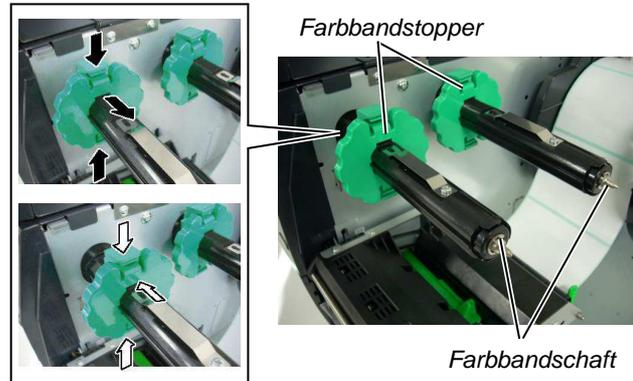
2. Führen Sie das Farbband lose, wie in der Abbildung gezeigt, auf den Farbbandschaft. Das Farbband muss zwischen den Antriebsblöcken hindurch geführt werden.
